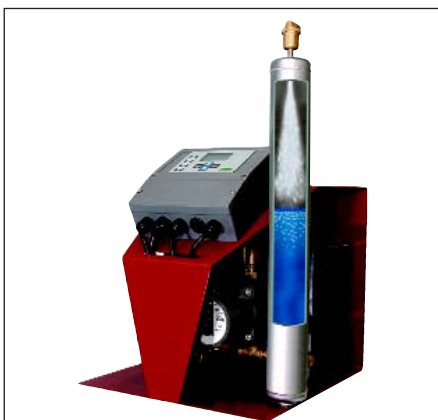
■ Bild 8: Beispiel für eine Entgasungsanlage. Die Versprühung im Vakuumrohr garantiert höchste Effektivität. Das hier gezeigte Modell findet in Heizungsanlagen mit bis zu 1 m 3 Wasserinhalt Anwendung.
